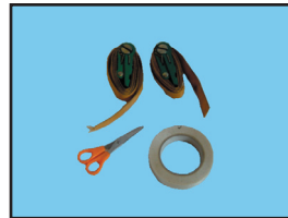
Hjælpeværktøj til montering af isoleringshalvskåle: Surringsværktøj uden kroge model Junior og armerings-tape.
